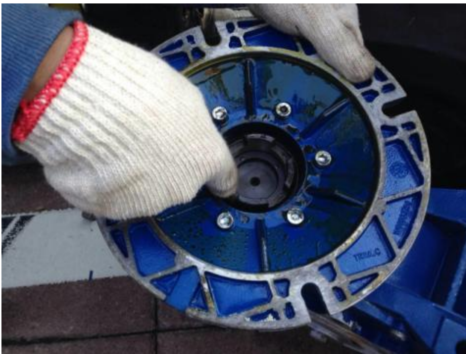
照片 8-2: 拆卸下來之減速機。
