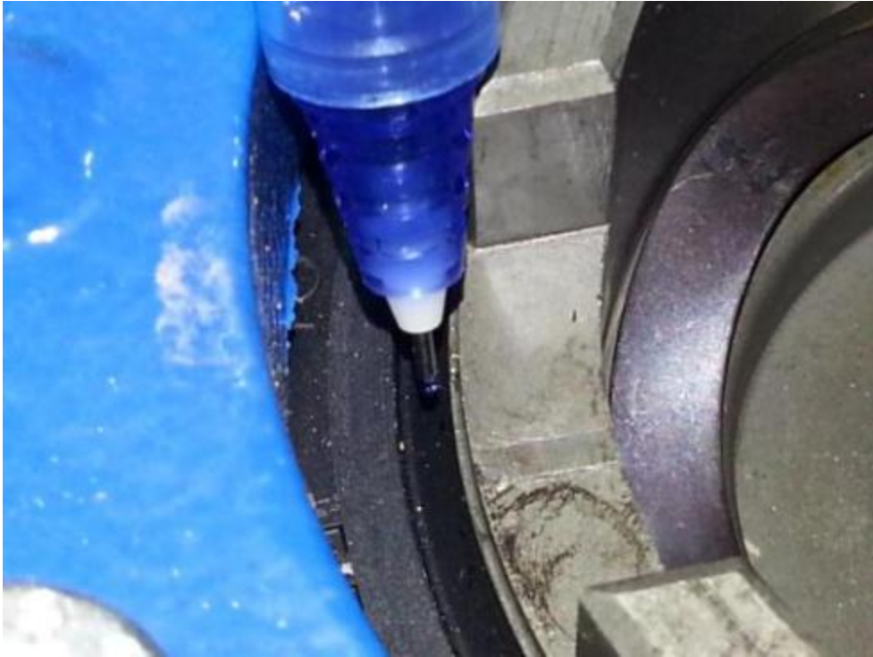
照片1：減速機油封圈(筆尖指處)。
