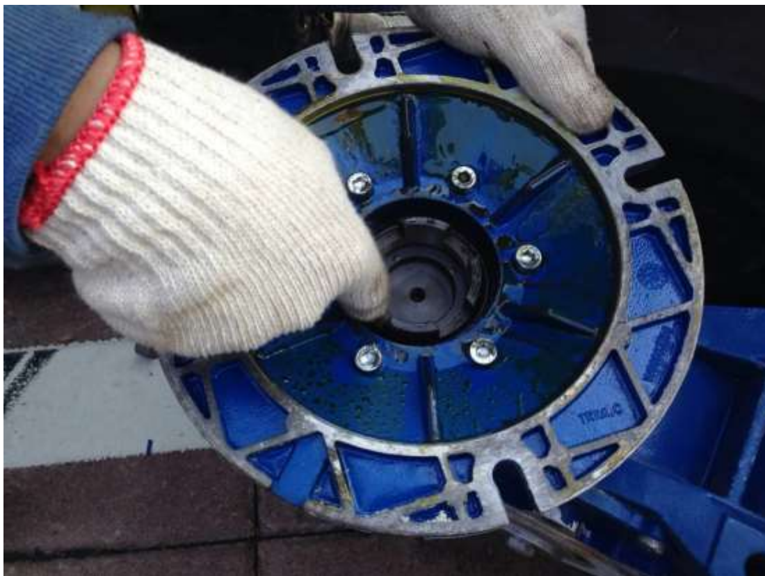
照片8-2:拆卸下來之減速機。
